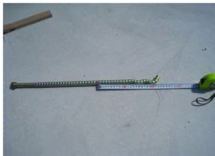
M16异形Sアンカーボルト 埋め込み長さ200mm以上
