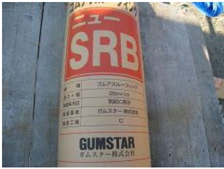
屋根防水下地アスファルトルーフィング
